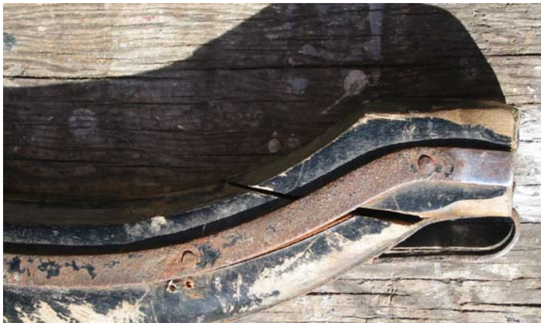
Bogtre med tverrved som har gitt brudd.
