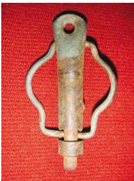
Patentpinne. Fordelen med denne er at den er rask å sette i lås. Ulempe. Låsen kan fort gå opp ved at men kommer borti ting, f. eks. kvister i skogen eller innvendig drag i parkjøring. Det er da viktig å sikre ved å tre en passe tykk lær-lisse gjennom låsen.
