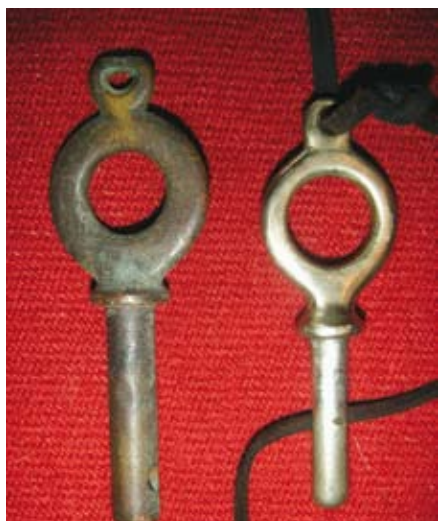
Selepinner av elghorn. Blir laget ved å dreie eller file dem til. Kan også kappe av en horn tapp av elghorn og bruk den direkte uten bearbeiding.
